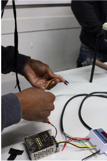
Figura 4. Montagem dos conectores elétricos
