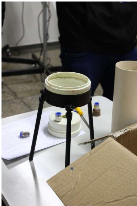
Figura 3. Montagem da base niveladora
