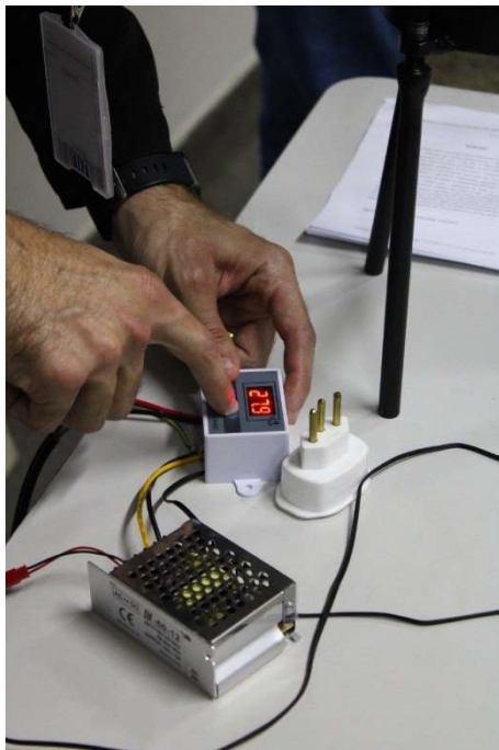
Figura 7. Programação e teste de partida do termostato
